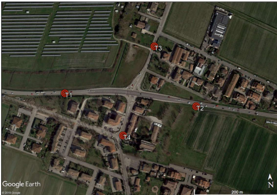
A seguito dell'analisi dei dati di traffico collezionati durante la campagna di rilievo è stato possibile definire i flussi veicolari circolanti sull'intersezione per ciascuna delle manovre presenti. Successivamente attraverso l'utilizzo di un modello di microsimulazione si è ricostruito il funzionamento dell'intersezione semaforizzata applicando i volumi di traffico veicolare riscontrati nell'ora di punta della mattina e proiettati al periodo invernale.
