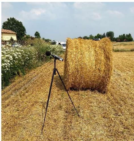
**Postazione 4\_spot** - È ubicata in prossimità del ciglio di via Gramsci. Il fonometro è stato collocato in corrispondenza di un campo incolto sita a est dell'asse viario di via Gramsci, precisamente alla distanza di 10 metri dal ciglio stradale e ad una altezza di 1,5 metri sul
