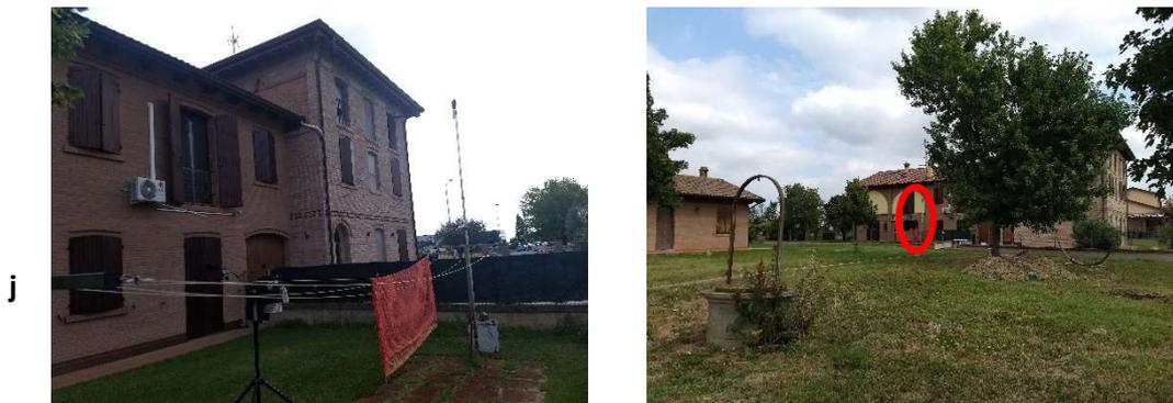
**Postazione 3\_spot** - È ubicata in prossimità del ciglio di via Matteotti SP3. Il fonometro è stato collocato in corrispondenza di una cavedagna sita a sud dell'asse viario di via Matteotti, precisamente alla distanza di 10 metri dal ciglio stradale e ad una altezza di 1,5 metri sul piano campagna. Tale postazione di rilievo ha permesso la caratterizzazione della specifica sorgente acustica di tipo lineare (via Matteotti SP3).
