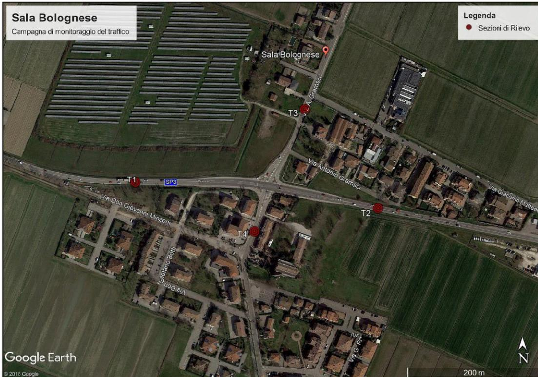
Contestualmente ai rilievi strumentali sui singoli rami dell'intersezione è stato condotto un monitoraggio con due telecamere al fine di poter monitorare la lunghezza delle code e ricostruire la matrice degli spostamenti sull'intersezione nei diversi periodi di punta della giornata.
