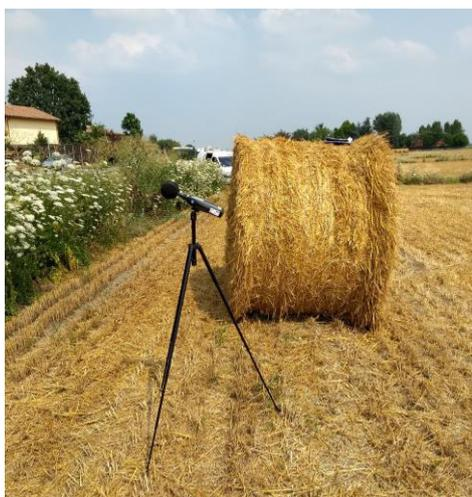
**Postazione 4\_spot** - È ubicata in prossimità del ciglio di via Gramsci. Il fonometro è stato collocato in corrispondenza di un campo incolto sita a est dell'asse viario di via Gramsci, precisamente alla distanza di 10 metri dal ciglio stradale e ad una altezza di 1,5 metri sul piano campagna. Tale postazione di rilievo ha permesso la caratterizzazione della specifica sorgente acustica di tipo lineare (via Gramsci).
