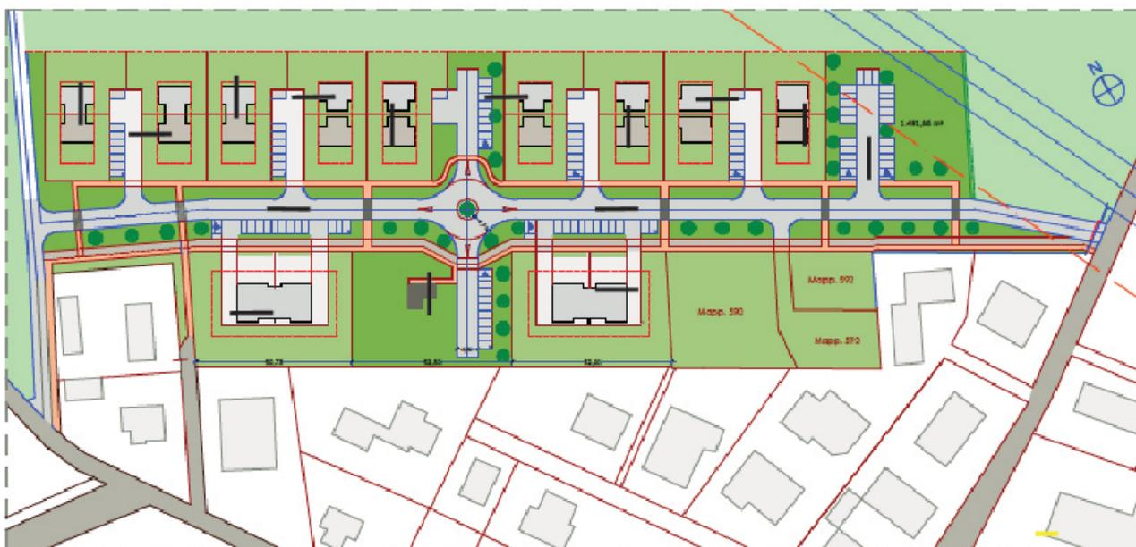
Fig. 12: ipotesi di posizionamento delle trincee esplorative (in nero).
