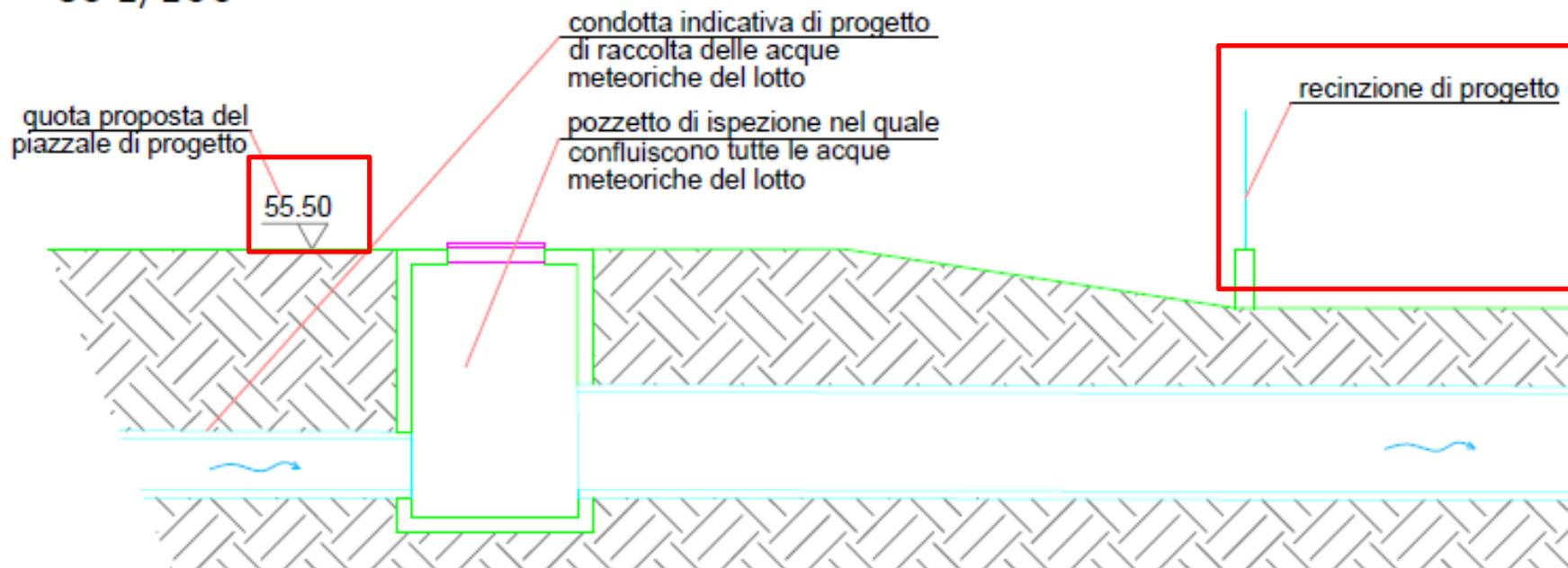
Figura 7 - Dettaglio sezione A-A lato piazzale di progetto - quota 55,50 m slm
