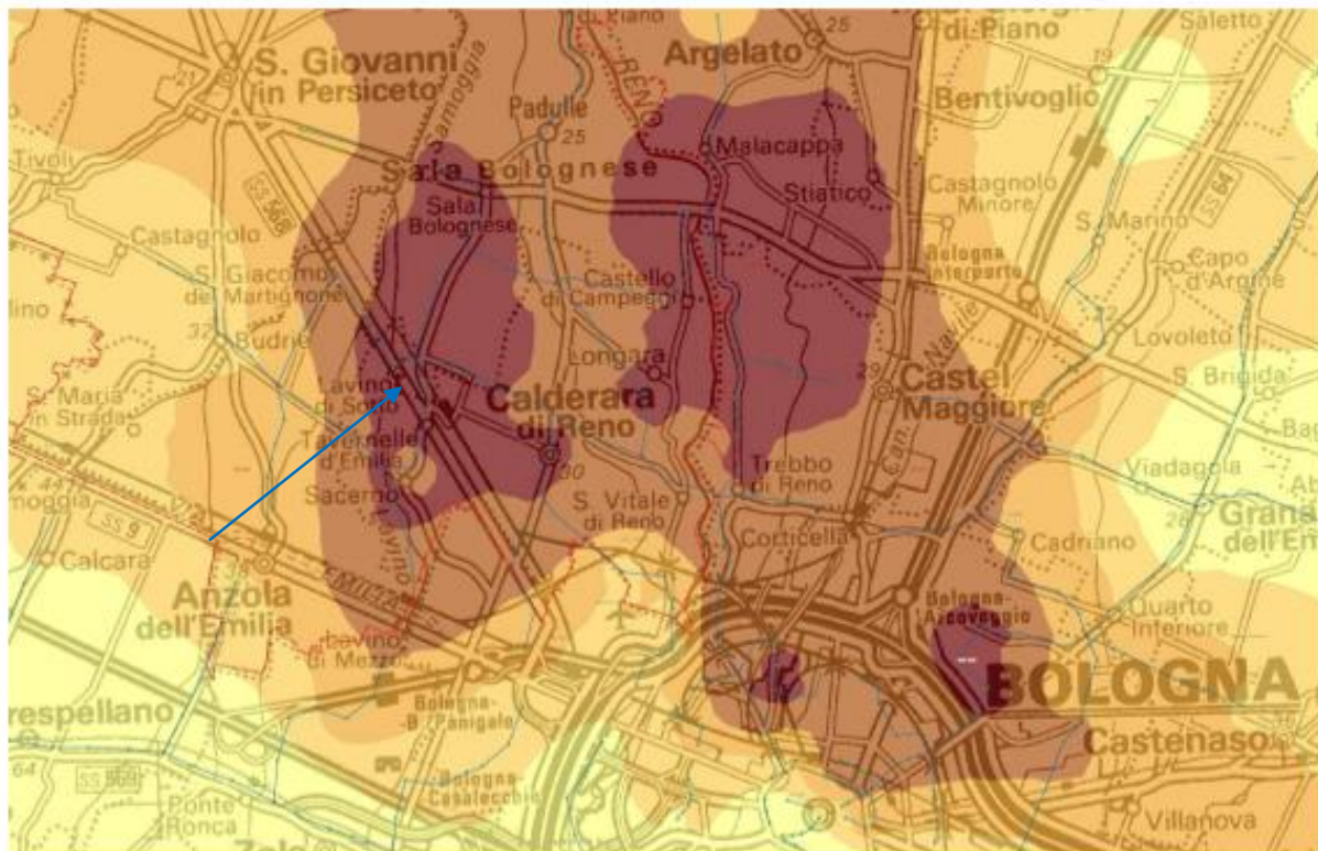
Fig. 6.8 - Estratto dell'elaborazione eseguita con i valori assoluti di subsidenza registrati tra il 1983-1999, dove a colorazione più intensa corrisponde un maggiore valore dell'abbassamento del suolo (il colore più scuro corrisponde ad un abbassamento di 100-120 cm).
