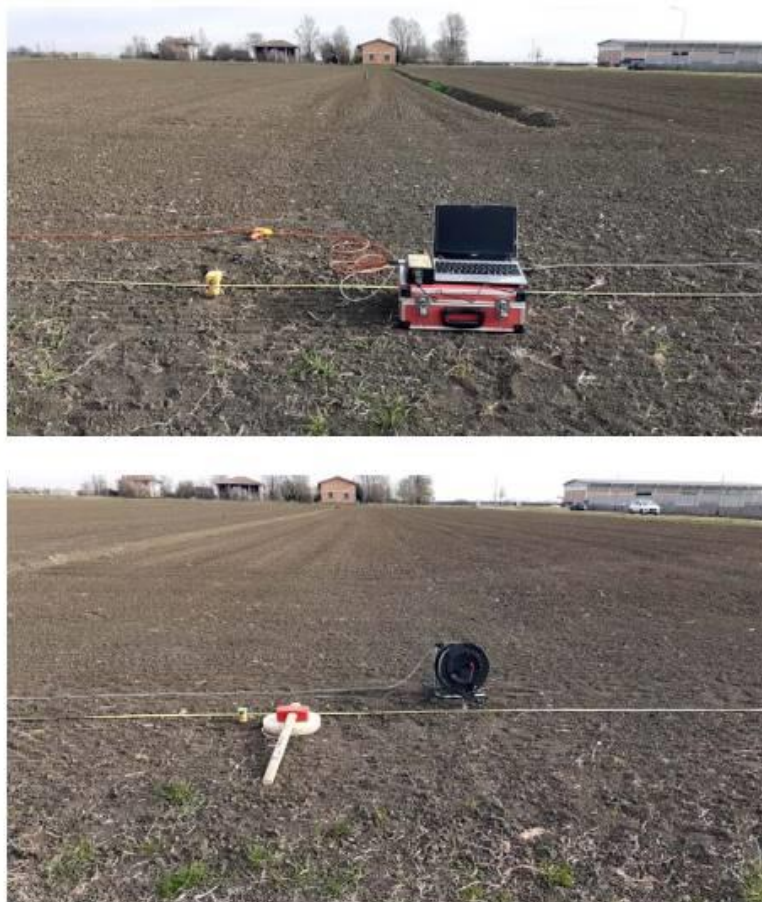
Figura 13 - Stendimento sismico Masw
