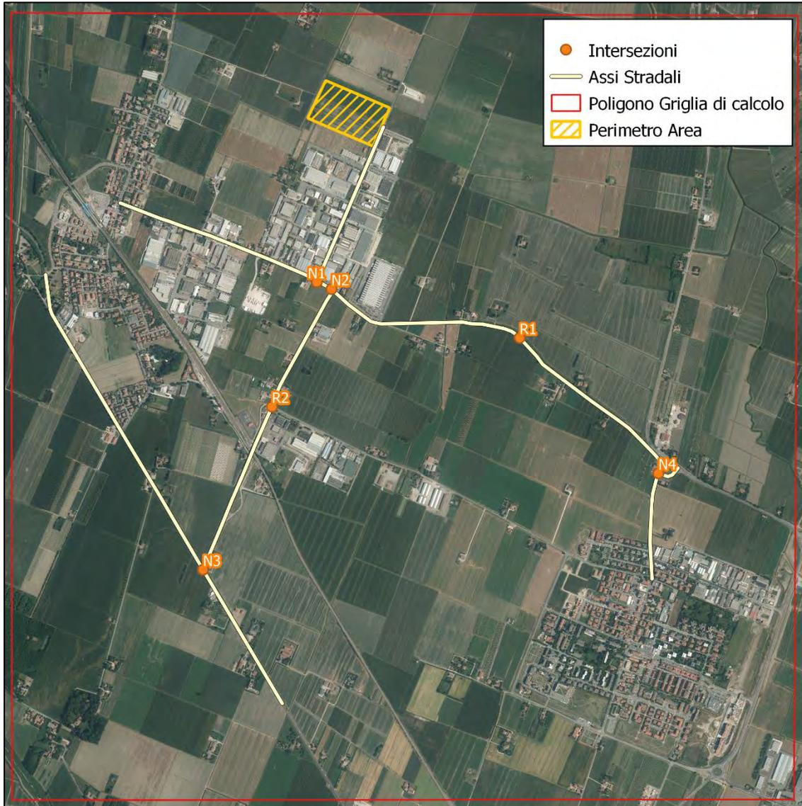
*Figura 4.1: identificazione degli assi stradali considerati nella simulazione modellistica e intersezione dove sono state effettuate le misure di traffico*
