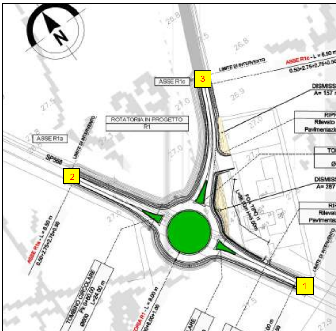
Img. 9.16 - Configurazione a rotatoria dell'intersezione F tra SP n.568 e via Valtiera nello scenario di progetto di lungo termine previsto dal POC
