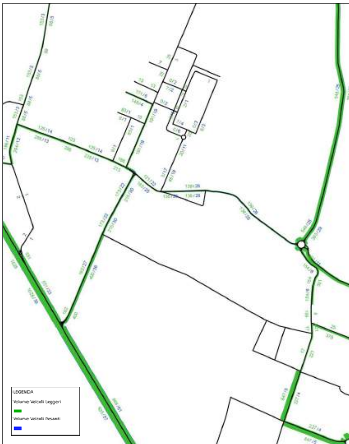
Img. 5.8 - Flussi di traffico nello scenario di progetto di PUA- ora di punta della mattina
