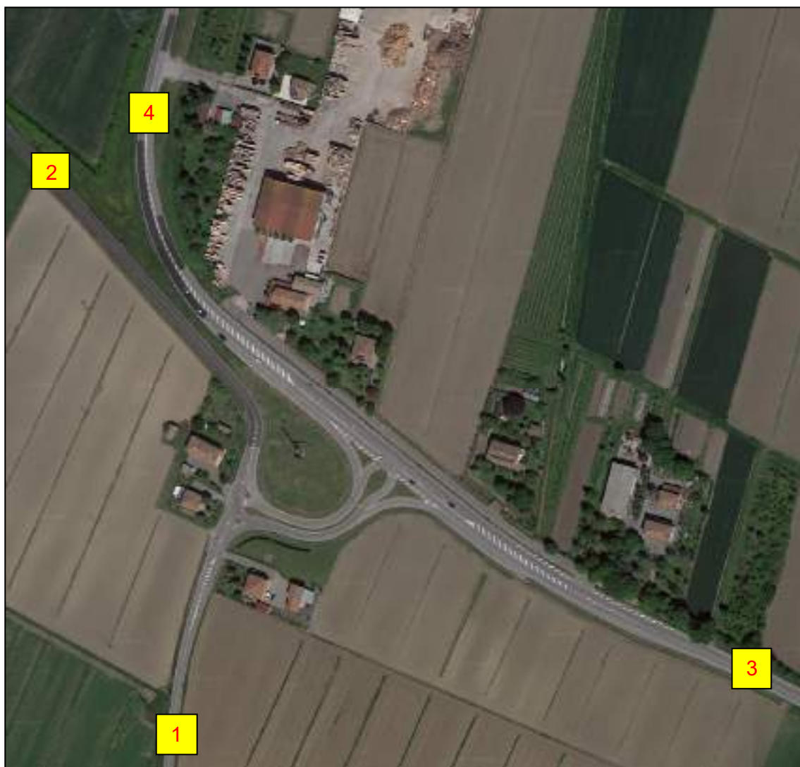
Img. 9.8 - Configurazione dell'intersezione D-E nello scenario attuale
