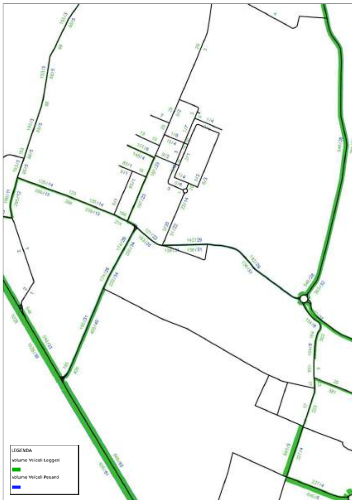
Img. 6.2 - Flussi di traffico nello scenario di progetto di POC- ora di punta della mattina
