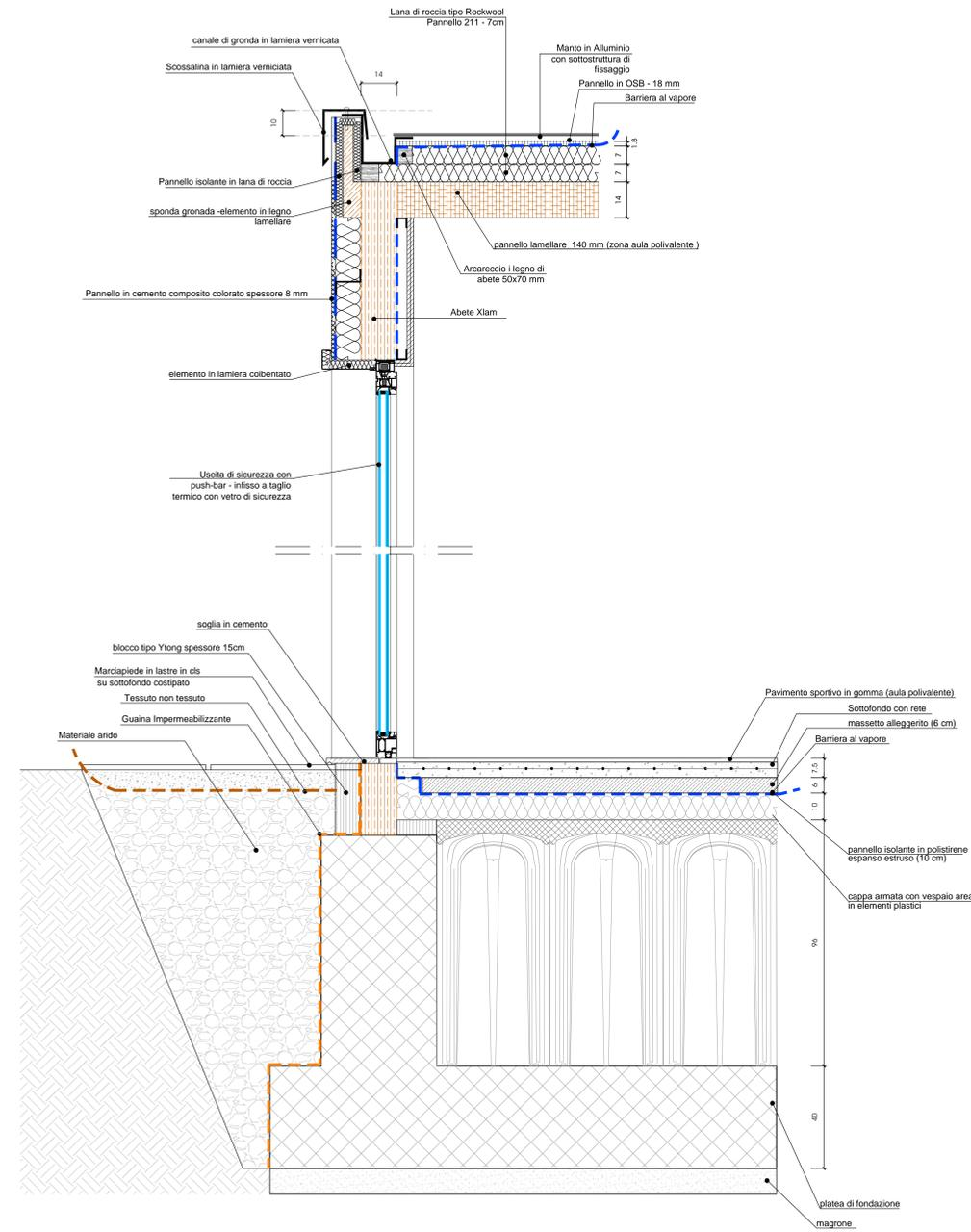
PARTICOLARE 4 GIUNTO COLLEGAMENTO-EDIFICIO ESISTENTE
