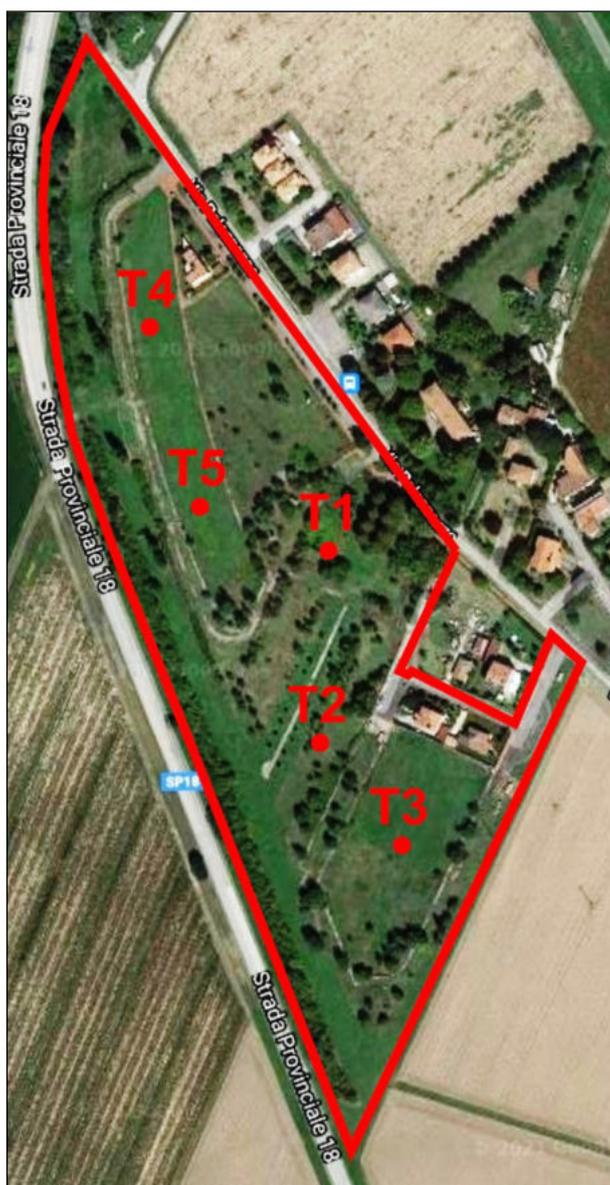
**Fig. 106 : Ubicazione delle trincee di esplorazione su fotografia aerea del 2018**
