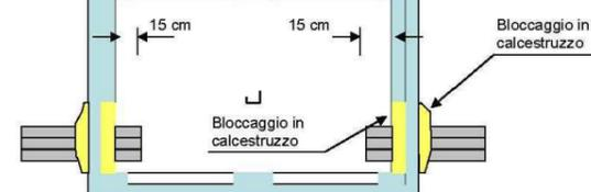
**Esempio di sistemazione tubi nei Pozzetti**
