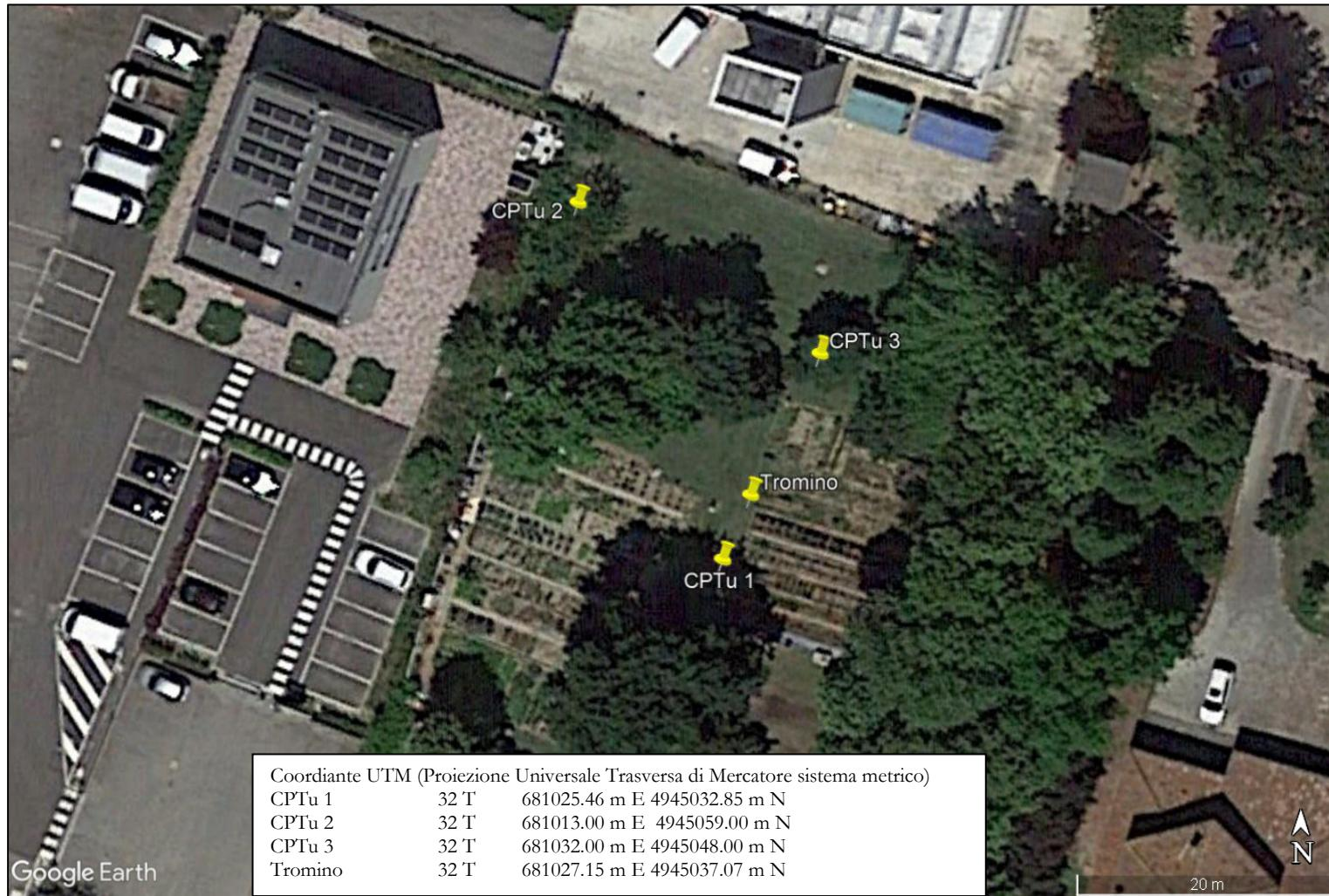
Fig. n. 3.2 – Ubicazione delle prove e su estratto di planimetria di planimetria catastale ingrandito alla scala 1:500
