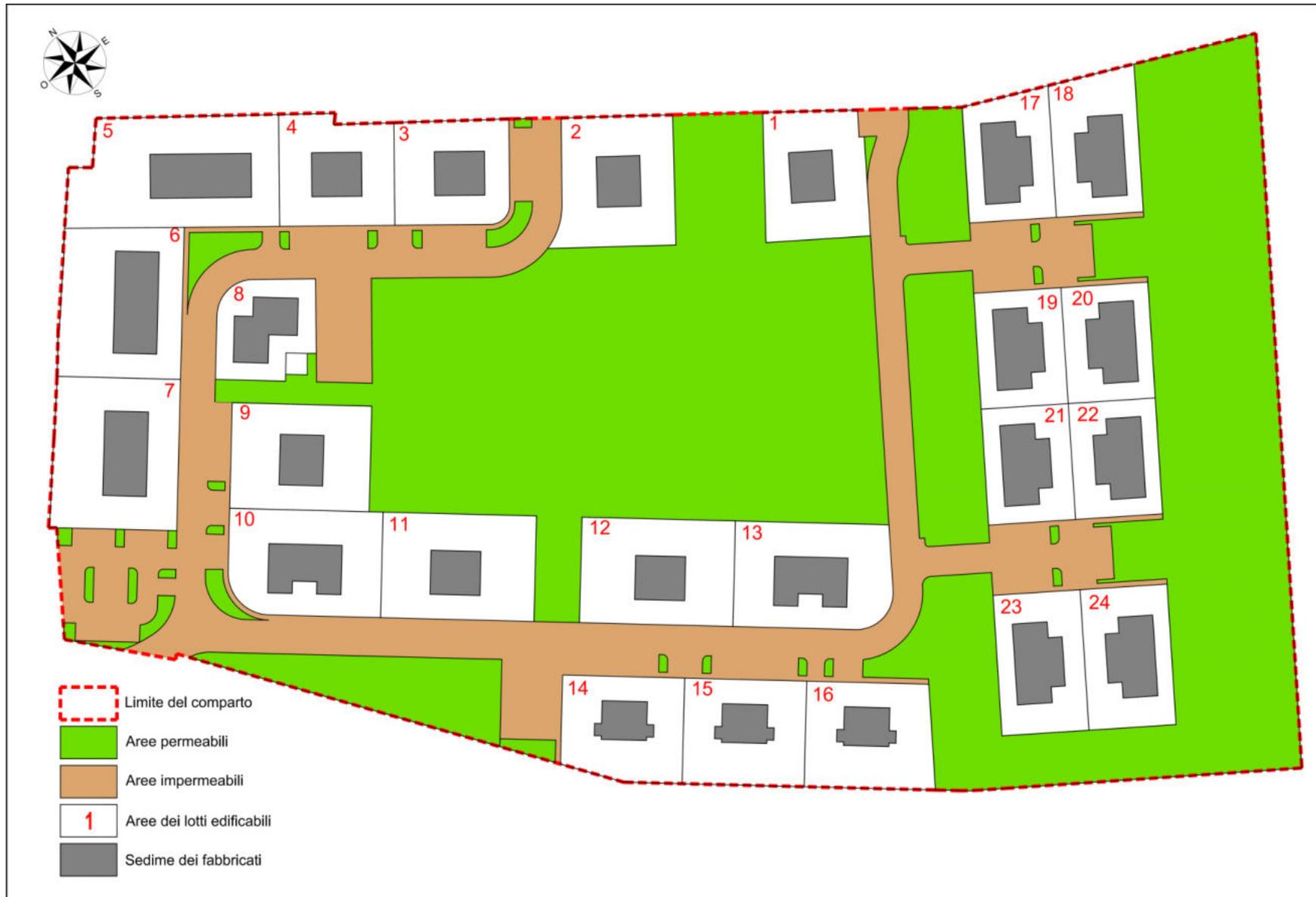
**Fig. 17 : Individuazione delle superfici considerate nel dimensionamento della vasca di laminazione**
