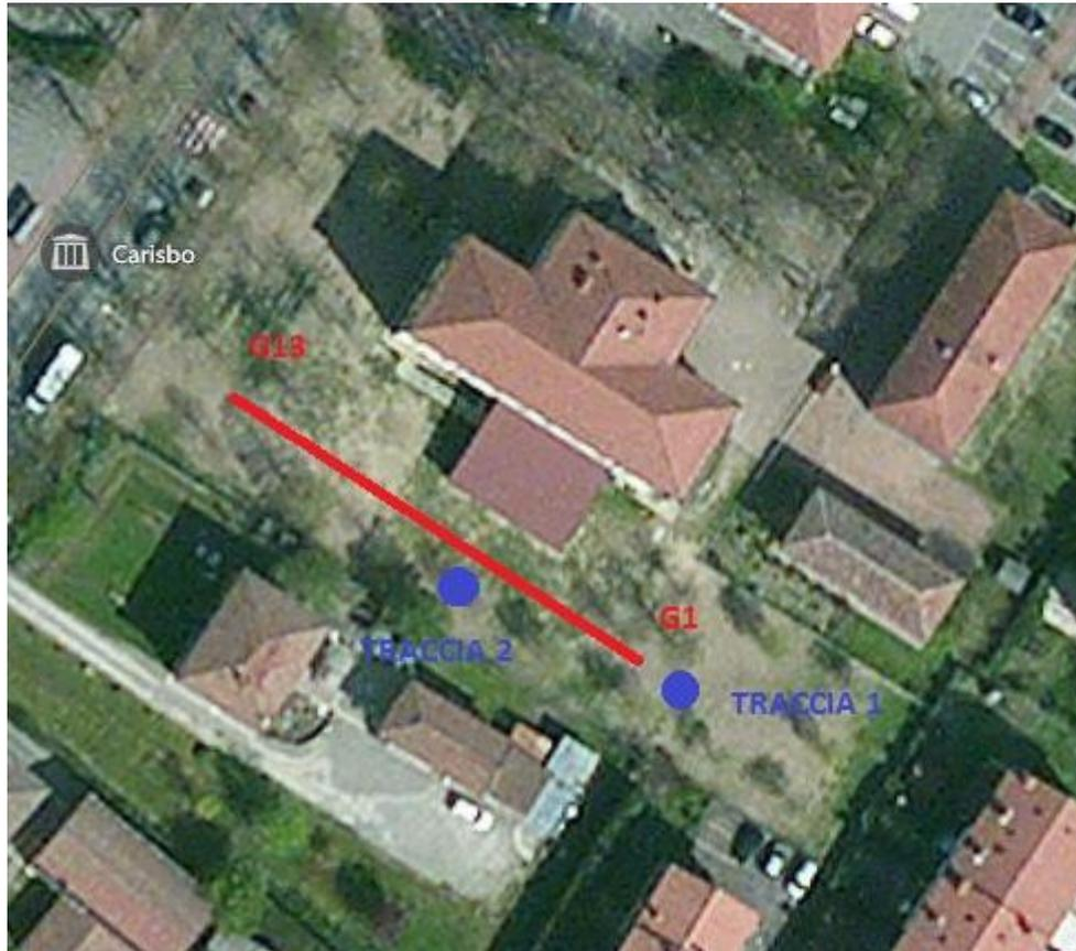
**Figura 1.** Ubicazione delle prova a stazione singola (blu) e in array (rosso).
