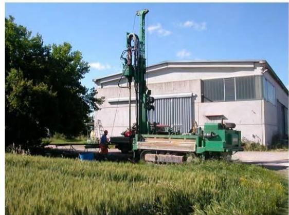
Prova CPT e Sondaggio S1
