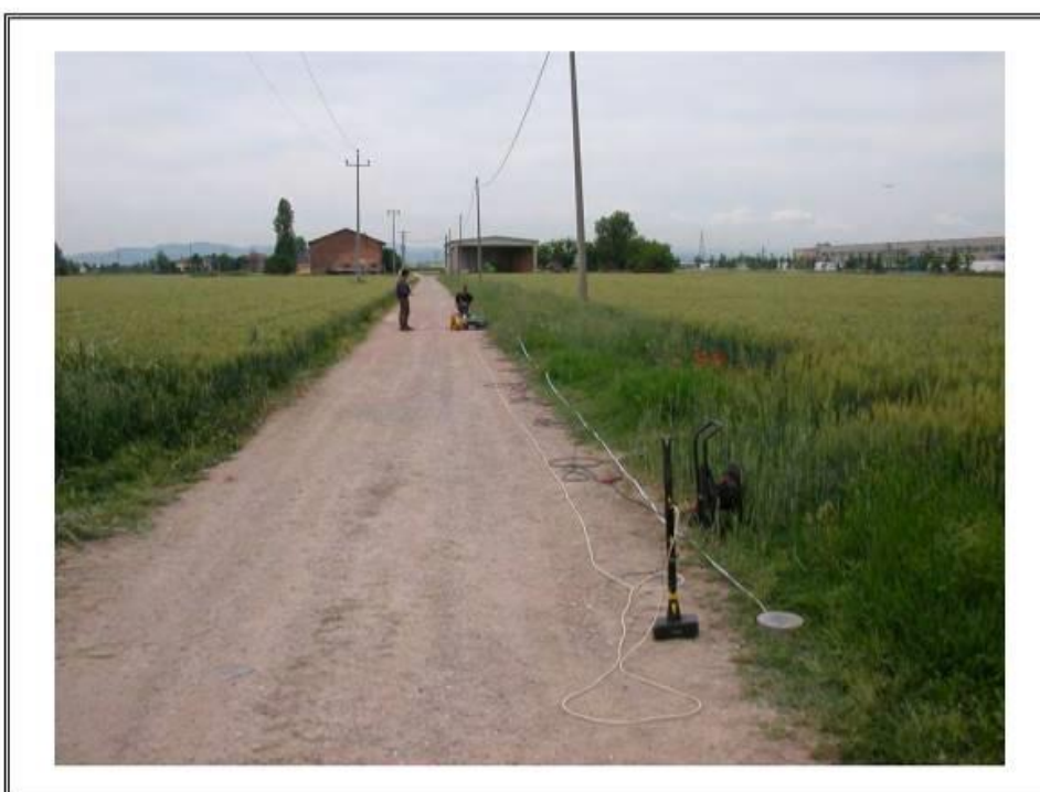
Stendimento sismico Masw1 e Masw2
