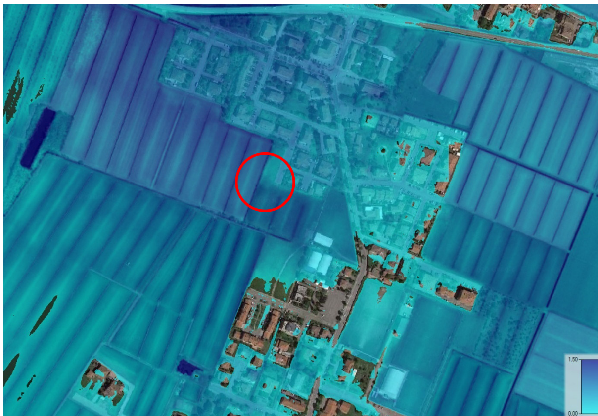
Figura 17 – Rappresentazione dell'esondazione per l'intera area studiata con i tiranti idraulici massimi raggiunti.
