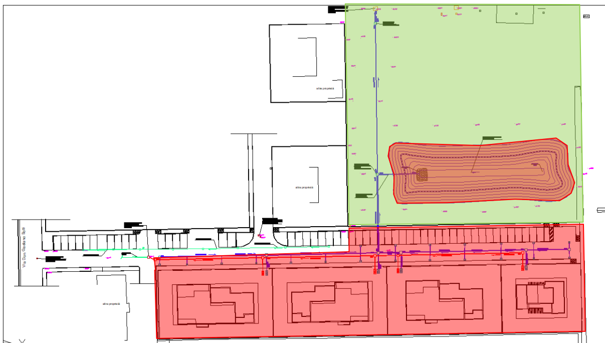
Figura 7 – Rappresentazione della superficie complessiva con evidenziata l'area drenata utilizzata per il calcolo del volume di laminazione (in rosso) e il verde compatto escluso dal calcolo (in verde).
